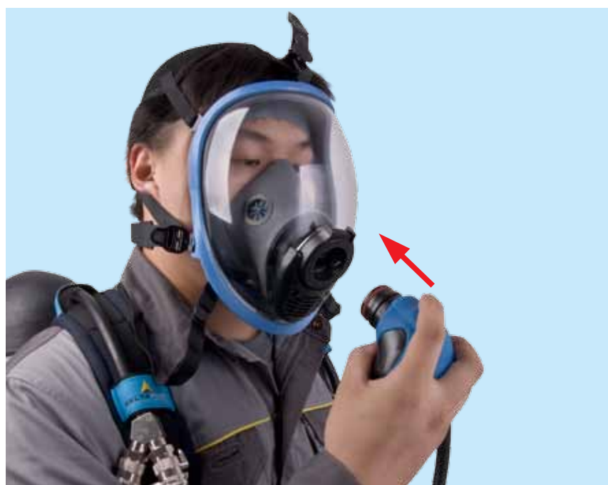
11. 将供气阀插进面罩供气口，与面罩正确连接，插入后听到“咔嚓”声表示连接到位。
