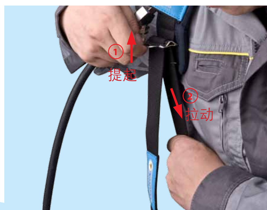
5. 松开肩带需把金属环拉起的同时拉动肩带，将肩带调整到最大长度。
