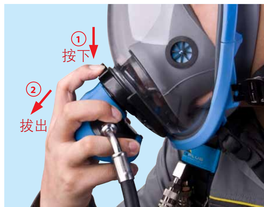
1. 手握供气阀同时食指按面罩上的卡口按钮后，可轻松地将供气阀从面罩上断开。
