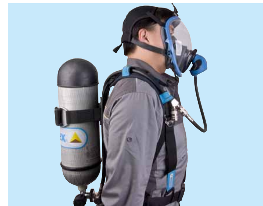
12. 佩戴完毕。此时无需手动打开供气阀，供气阀会随着使用者的呼吸自动打开并实现按需供气。
