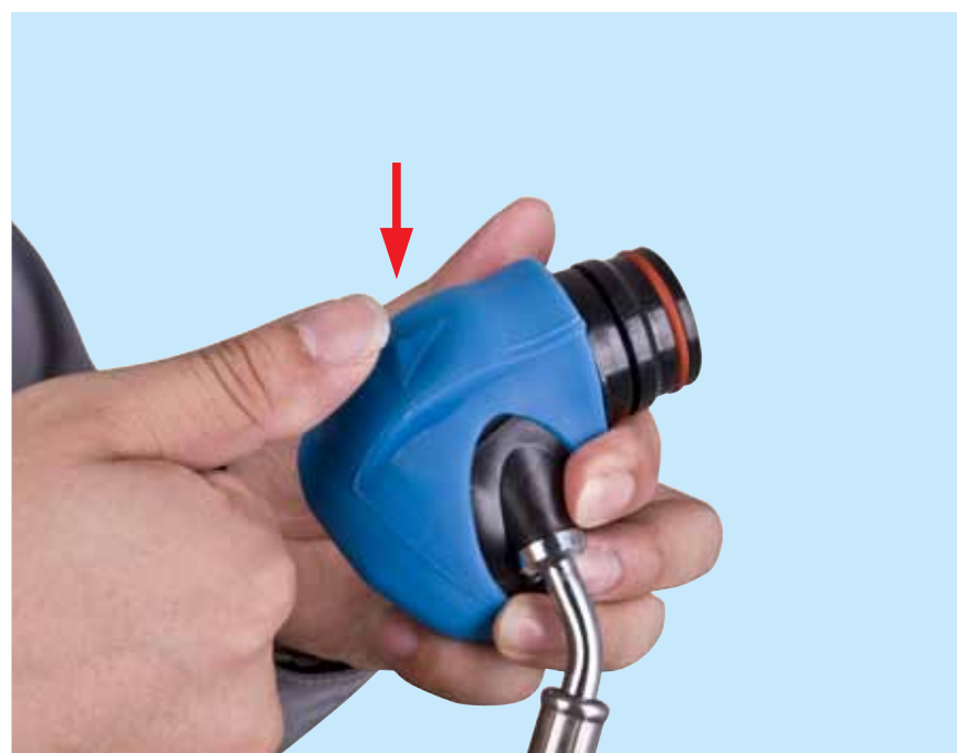
9. 按下供气阀上三角形关闭按钮，关闭供气阀。
