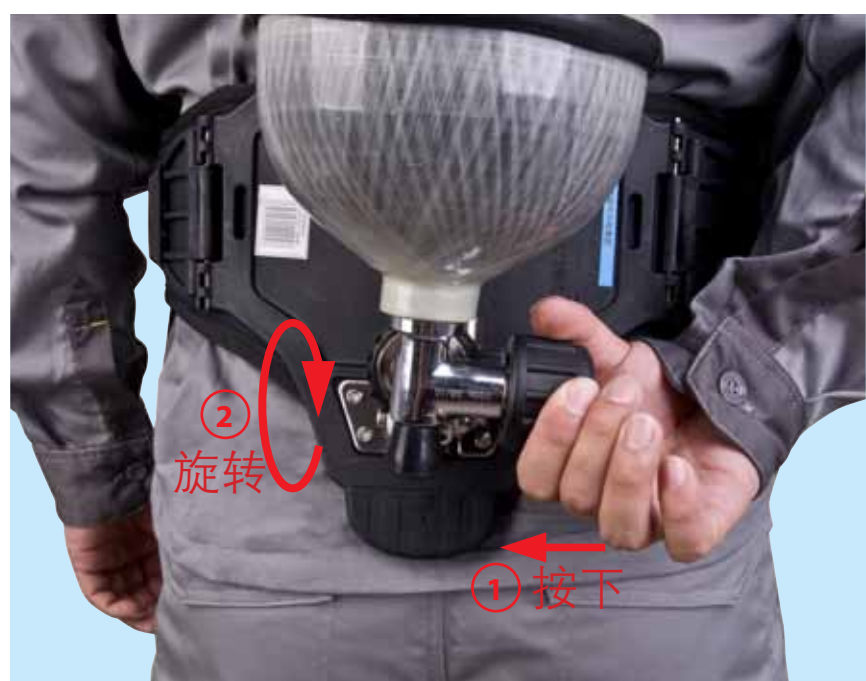
2. 关闭气瓶阀门。气瓶阀门需要沿轴向施力后才能顺时针旋转关闭。
