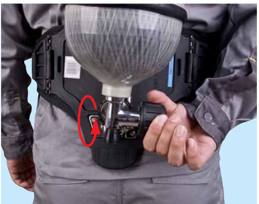
10. 逆时针旋转打开气瓶阀，打开至少两圈以上。
