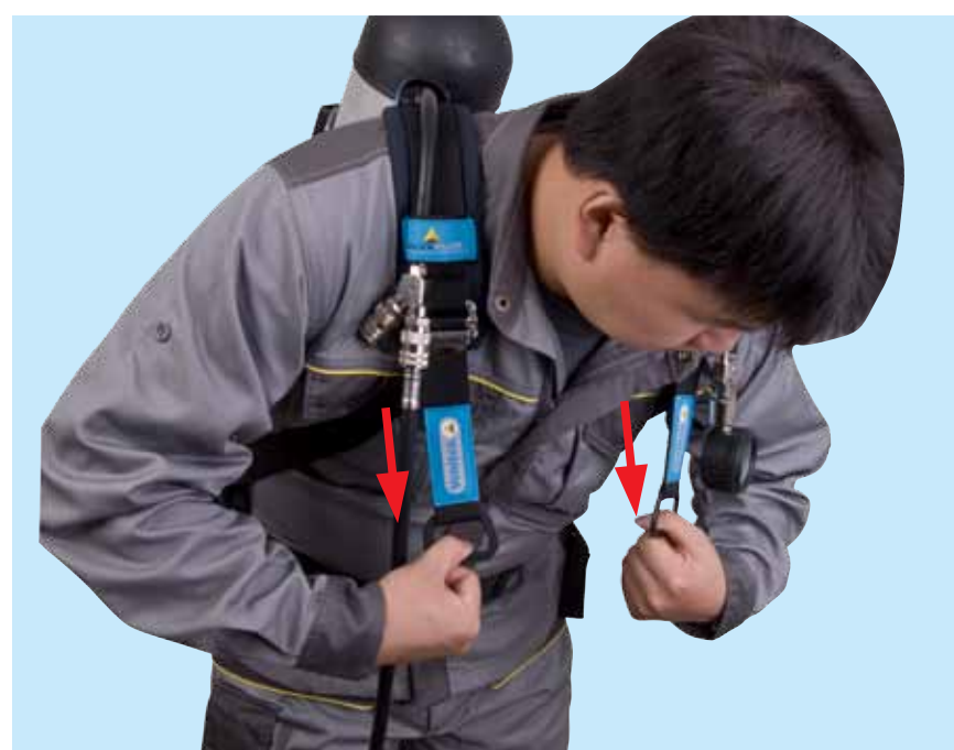
2. 双手扣住D型环，身体前倾，拉紧直到肩带及背架与身体充分贴合且佩戴舒适。
